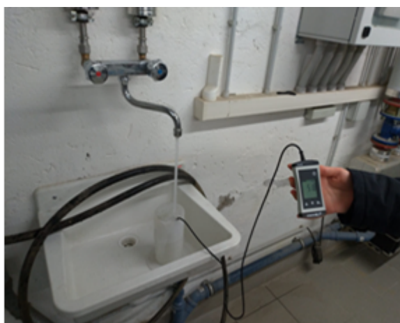
Fig. 4 – rilevazione temperatura acqua calda sanitaria in mandata presso lavabo servizio locale centrale termica
